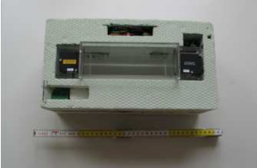
Abb. 6: Die geöffnete Flying Parsivel-Sonde. Erläuterungen siehe Text.
