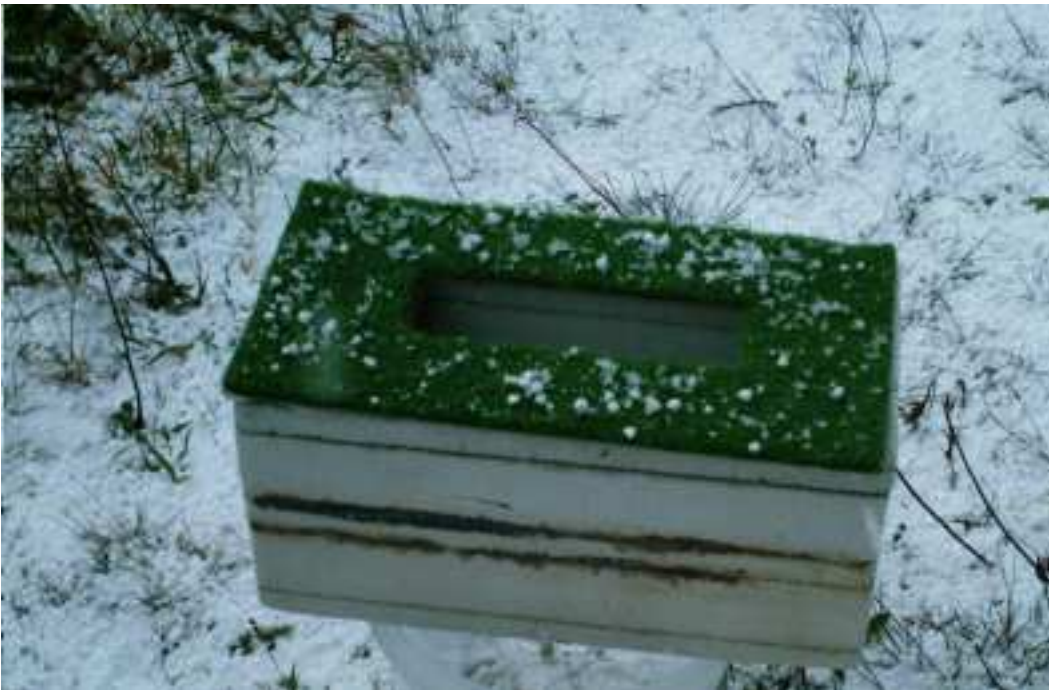
Abb. 7: Flying Parsivel-Sonde bei der Messung von Graupel. Auf der Sonde befindet sich eine Kunstrasenaufgabe (Reduktion von Spritztropfen).
