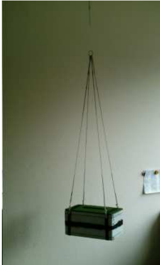
Abb. 15: Flying Parsivel-Sonde mit Aufhängung.
