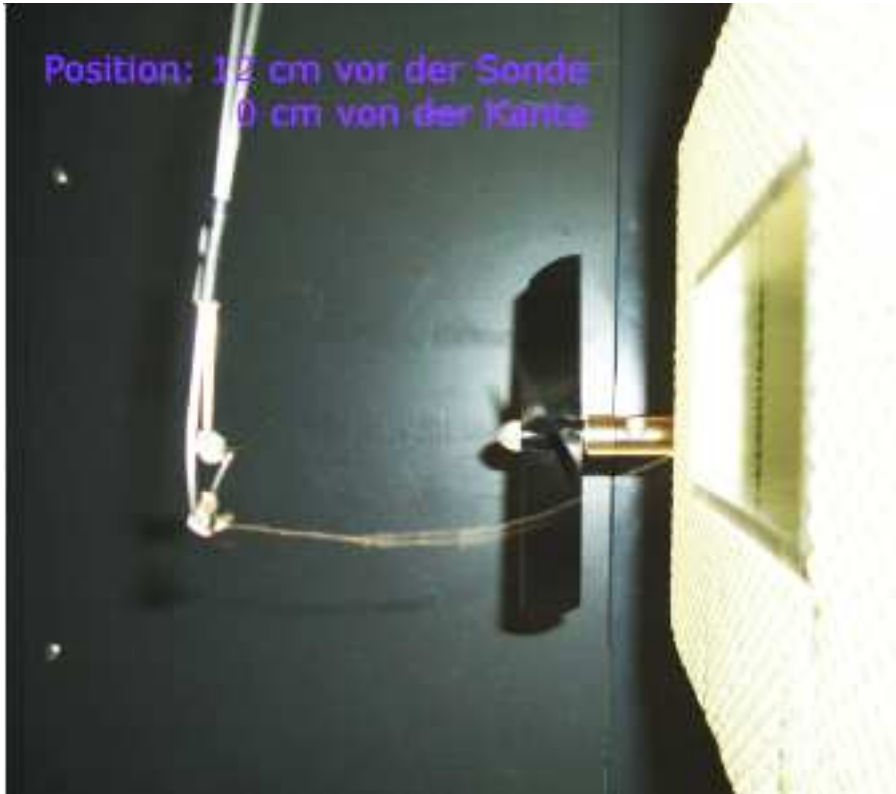
Abb. 27: Sichtbarmachung des Strömungsverlaufs an der breiten Seite (mittig) der Flying Parsivel-Sonde durch einen sehr feinen Faden.
