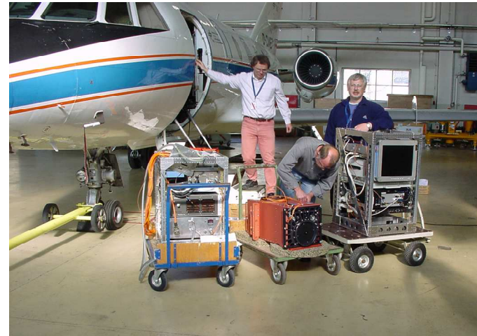
Komponenten des 2 \mu\text{m} Doppler Wind Lidars für die Windprofilmessung auf der Falcon
