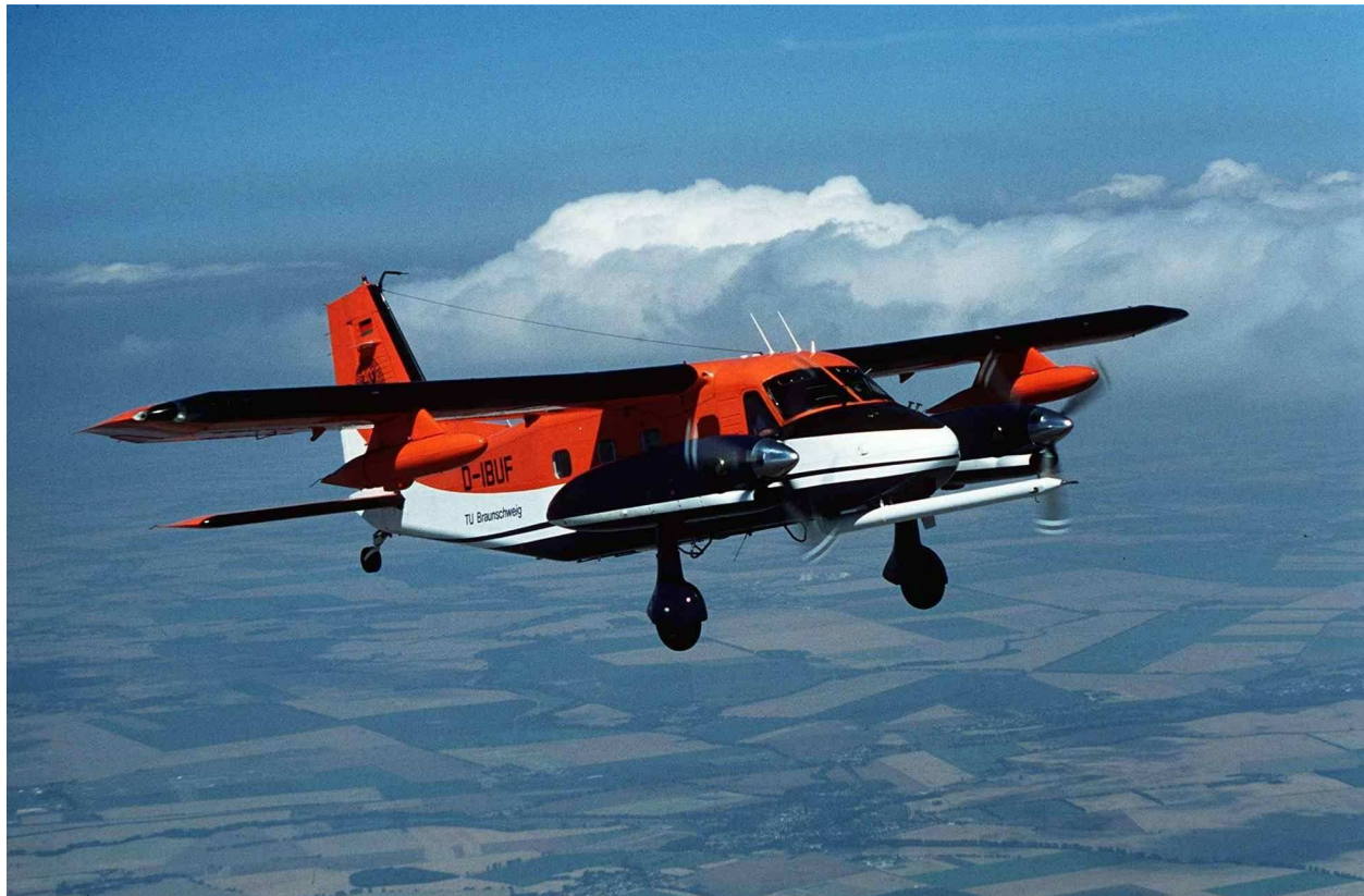
Abb. 1: Das Forschungsflugzeug DO 128, Rufzeichen D-IBUF: An der Spitze des Nasenmastes befinden sich Sensoren für die Messung der meteorologischen Parameter Wind, Temperatur und Feuchte.
